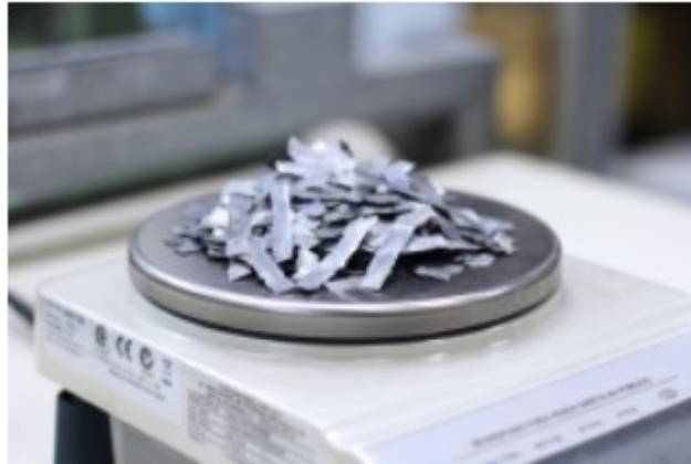
Primeiras tiras de liga didímio-ferro-boro obtidas a partir da técnica de strip casting. Espessura e composição química das tiras têm efeito direto no bom desempenho de superímãs
